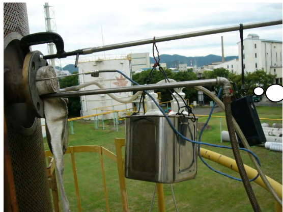
【排ガス測定中】 かなり高所での作業もあるので、安全第一でやってます。 足元注意！！
